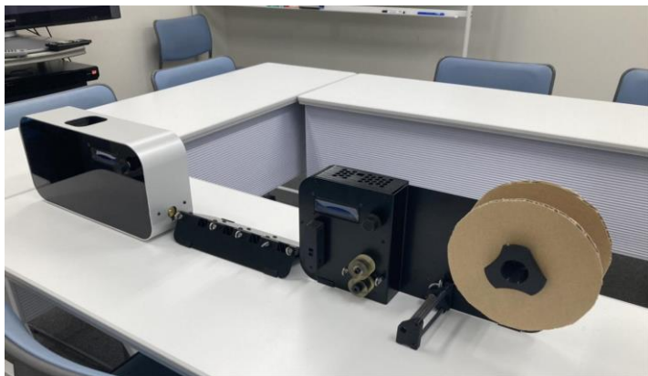
画像：著者撮影（左から原料溶解機・乾燥機・巻き取り機）
